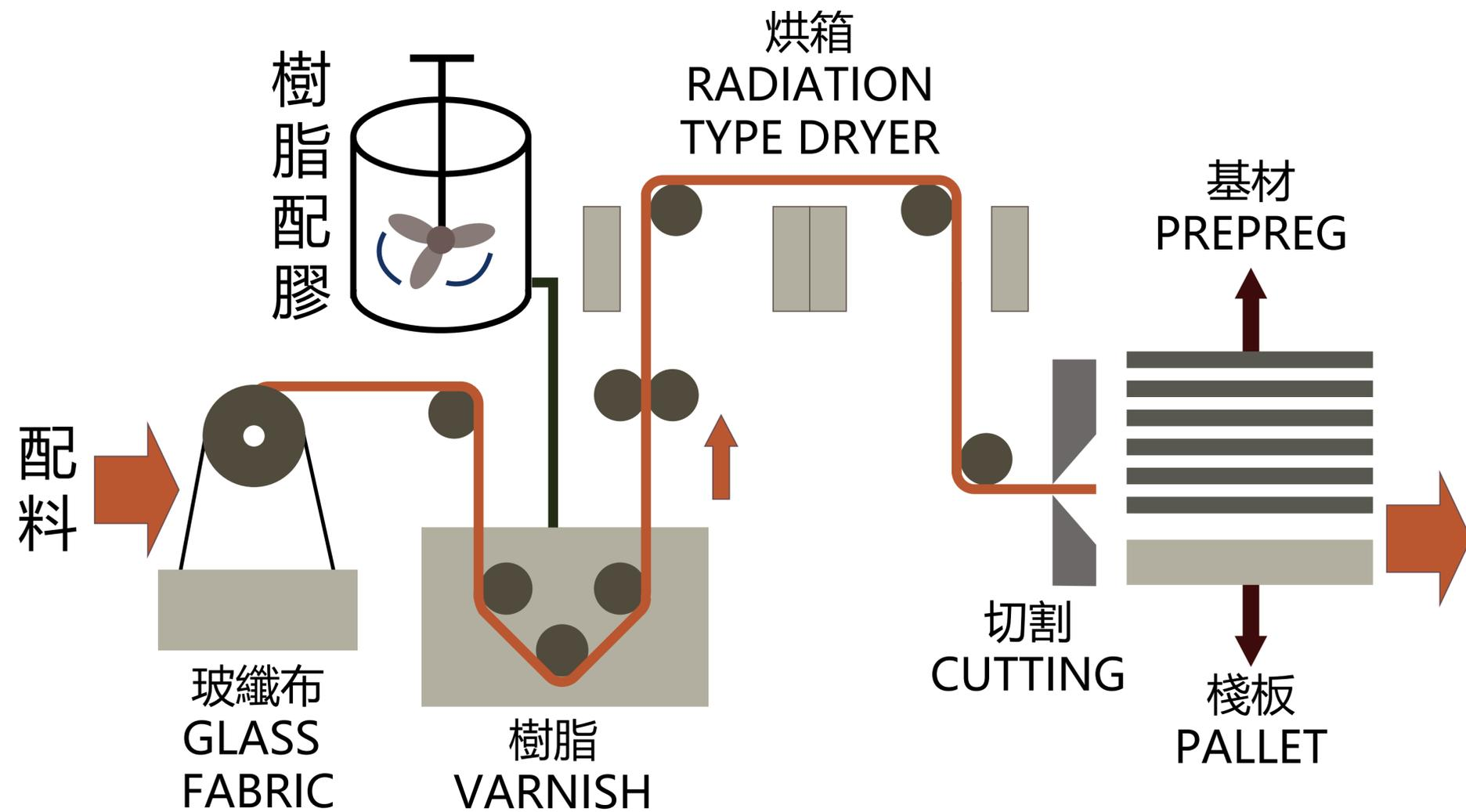
將玻璃纖維布含浸樹脂，並利用熱能使溶劑揮發及進行架橋反應使成為半硬化之基材。
